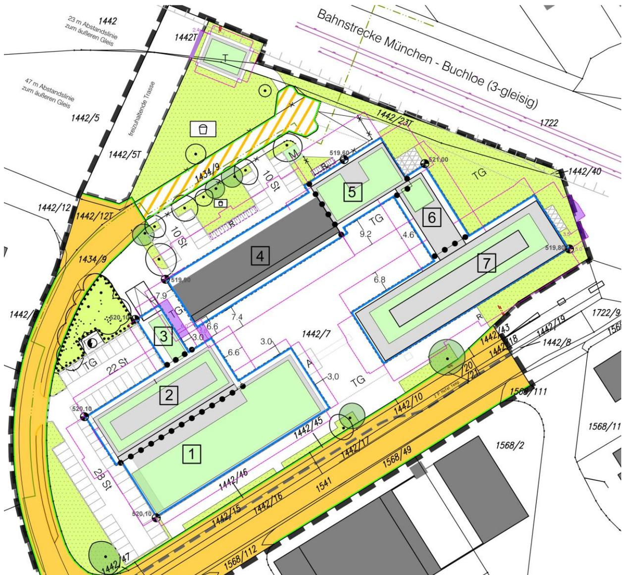
Abb. 8: Bereiche mit möglicher Unterschreitung der Abstandsflächen 0,4 H bzw. mind. 3 m gemäß vorliegendem Bebauungsplan am Alois-Harbeck-Platz (lila markiert), die bemäßen Abstandsflächen berücksichtigen die erhöhte Lage des Platzes.
